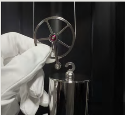
Ein besonderes Detail, die Seilrolle ist rubingelagert. A special detail: the rope pulley with jewelled bearings.
