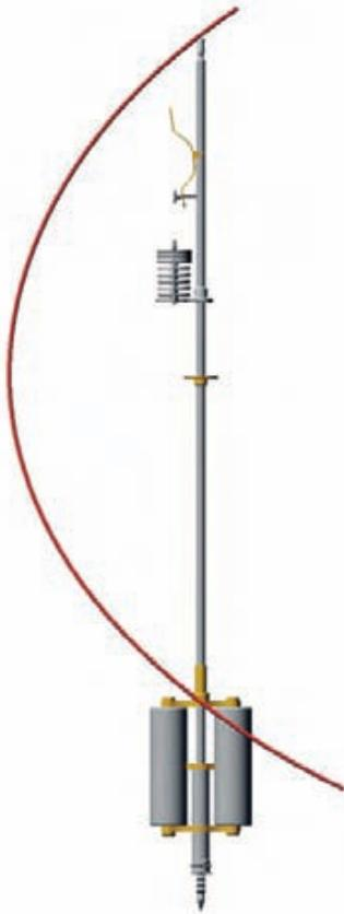
Bei steigendem Luftdruck erhält das Pendel mehr Auftrieb und die Luftreibung vergrößert sich. Das Pendel würde ohne Kompensation langsamer schwingen und Ihre Uhr ginge nach. Die Aneroiddosen der Luftdruckkompensation werden zusammengedrückt.
