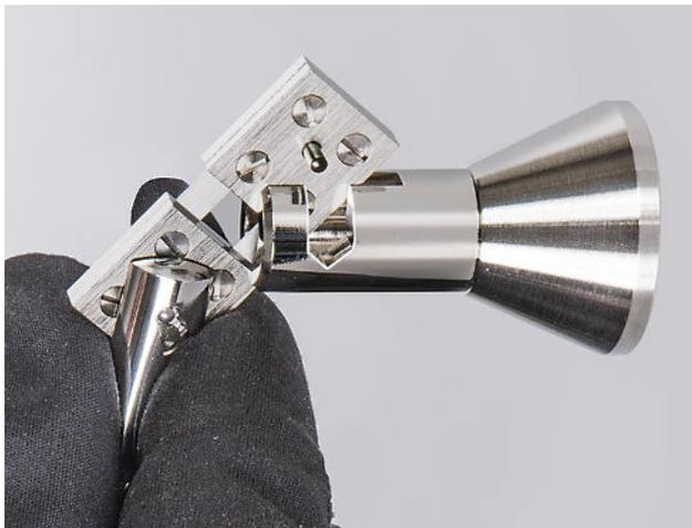
Schieben Sie anschließend das Schutzrohr wieder auf den Pendelgalgen. Richten Sie durch Drehen der seitlichen Rändelmutter die Pendelskala so aus, dass die Spitze des Pendels exakt auf die »0« zeigt.
