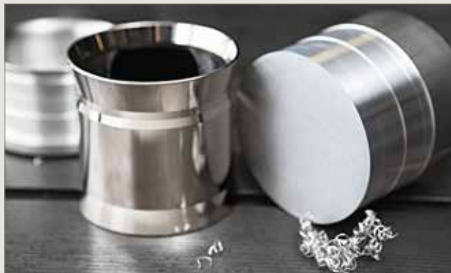
Das hochwertige Herzstück der Uhrenbeweger wird aus Gewichtsgründen aus Aluminium gedreht. To keep the weight down, the high-quality centrepiece of the watch winder is milled from aluminium.
